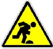
PERICOLO DI INCIAMPO
