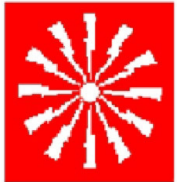
PULSANTE DI ALLARME ANTINCENDIO
